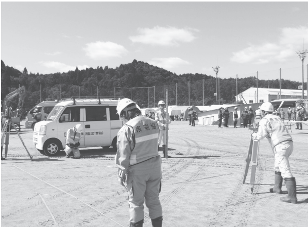
堤防決壊の状況調査を行う奈良県測量設計業協会
