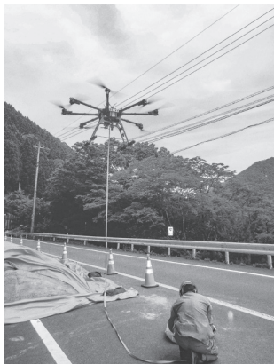
60kgの吊上運搬が可能なT5Aドローン
