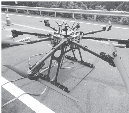
60kgの吊上運搬が可能なT5Aドローン
