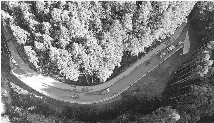
・工事延長L||108m、場所打擁壁工(重力式擁壁)L||48m、補強土壁工L||66m、路側防護柵工(ガードレール)L||108m
