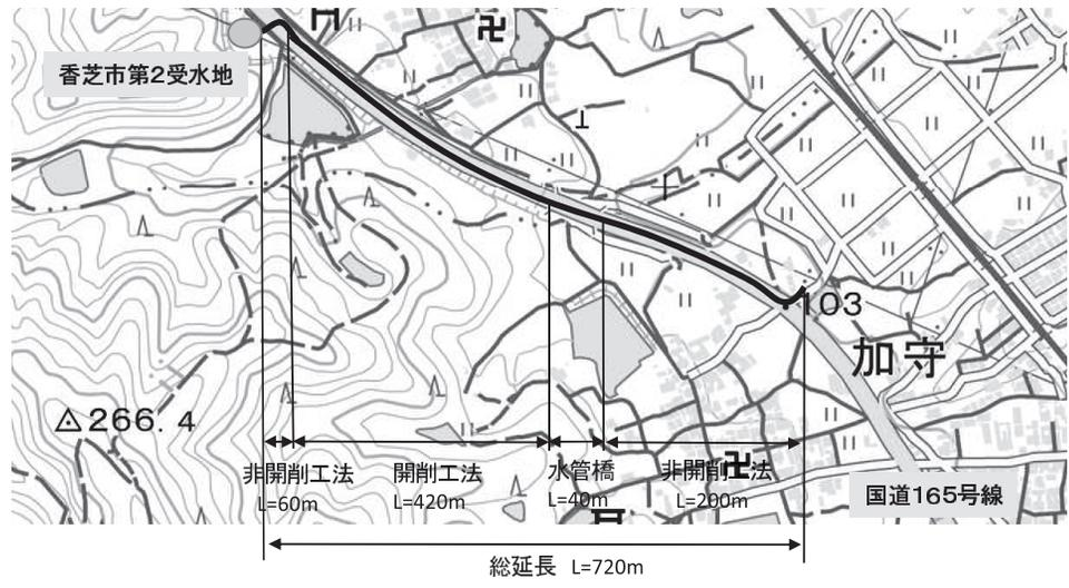
更新管は呼び径φ300。起点は西部幹線(加守集合弁室)鋼管φ1200。終点は香芝市第2受水地鋼管φ500。この業務において検討するルート等の位置については図を基本とし、施工延長を720(開削工法呼び径φ300、L420、非開削工法呼び径φ300、L260、水管橋呼び径φ300、L40)と想定している。
