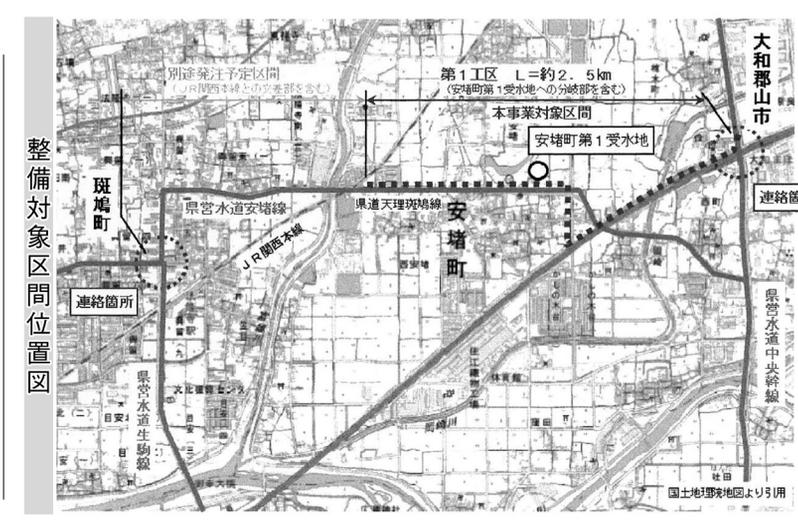
を確保する(図参照)ため、御所浄水場からの送水系統である中央幹線と、桜井浄水場からの送水系統である生駒線を安堵町第1受水地と接続する。また、安堵連絡管整備事業は、平常時に御所浄水場から磯城郡3町への送水ルートで事故が発生した場合に備え、桜井浄水場から磯城郡3町への送水バックアップルート
