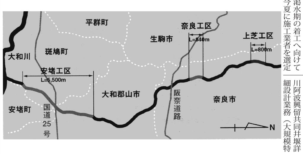
年1回程度の確率で発生する降雨による洪水を安全に流下させることとする。大和川水系生駒いかるが圏域河川整備計画に位置付けられる富雄川のうち安堵工区は、安堵町等目の高瀬井堰と大和郡山市外川町の外川橋の区間約5500m。現況の河道法線をもとに河道断面の拡大(河床掘削)を行う。高水敷は河川空間の利用が図れるよう整備に努める。また、広域自転車道整備とも連携しながら河川工事を実施するとともに、周辺の田園・集落の景観に調和した自然環境の復元を図る。
