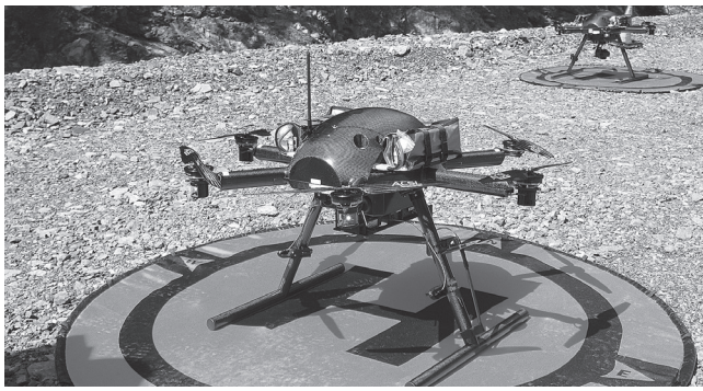
撮影用と中継用の2機で点検
