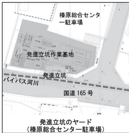
奈良県東区間の発進立坑作業基地は榛原総合センター駐車場の一部を利用します。地下バイパス河川は直径1.2mの管を1/355の縦断勾配で設置します。地上から地下バイパス河川までの深さは5.6m、25.6mとなり、長距離の推進工法で工事を行います。地下の岩の圧縮強度が14.5MN/m<sup>2</sup>(標準的なコンクリートの圧縮強度24MN/m<sup>2</sup>の約6倍)と大きいいため、その強度に対応可能で推進機の先端ビットを交換可能なCMT工法(複合推進工法)を採用します。掘削土砂は坑外で処理土と泥水に分離し、処理土はトラックで運搬、泥水は再利用します。
